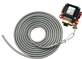
Húzókapcsoló műanyag húzókötéllal Vízszintesen vagy függőlegesen szerelhető, öntött alumínium ház, IP 65, kábel hossza 4 m
