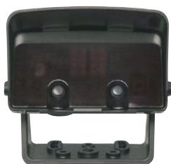
MWD-C radaros mozgásérzékelő gyors és célzott automatikus kapunyitás, irányfelismerés, max. szerelési magasság 7 m, mélyhűtött területre legfeljebb -22 °C-ig szerelhető, IP 65
