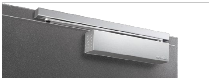
Deurdranger H-TS 93, optionele uitvoering voor directe montage zonder lateihoekstuk
